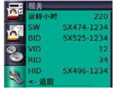
在“服务”信息下，显示呼吸机运行小时数和软件识别号
